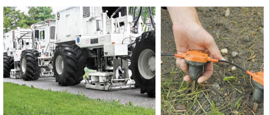
Die Vibrationsfahrzeuge sehen unheimlich aus, sind es aber nicht: Sie erzeugen die Schallwellen, die im Untergrund reflektiert werden.
