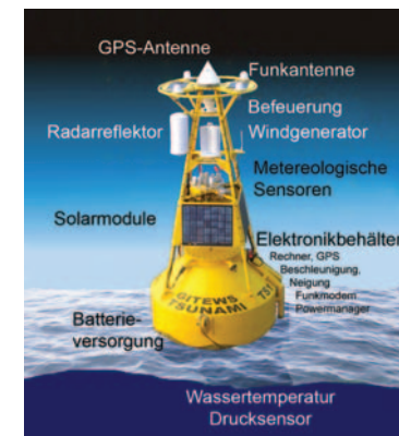
Schematischer Aufbau der GPS-Boje
